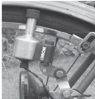
■ Gambar 7.8 Dinamo sepeda digunakan untuk menyalakan lampu.
