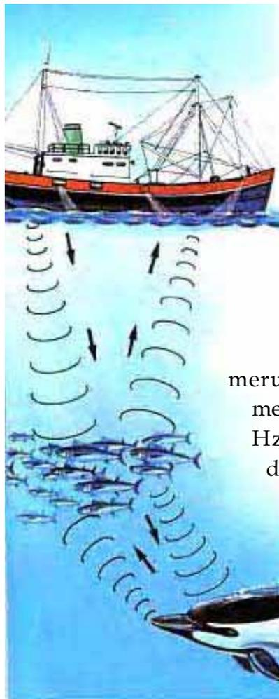
Sonar atau *Sound Navigation and Ranging* merupakan suatu metode penggunaan gelombang ultrasonik untuk menaksir ukuran, bentuk, dan kedalaman benda-benda di bawah air. Metode ini digunakan antara lain untuk menentukan posisi kawanan ikan di bawah air, seperti **Gambar 10.29**.
