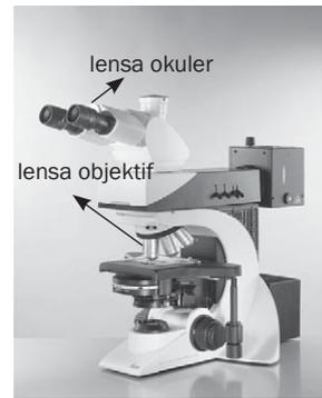
**Gambar 20.12 Bagian-Bagian Utama Mikroskop**
