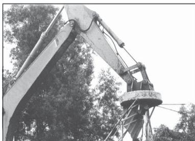
**Gambar 7.20** Alat pengangkat rongsokan logam.
