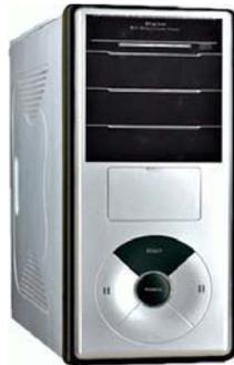
Merupakan bagian penting komputer seperti halnya otak pada berfungsi sebagai pengolah informasi dimasukkan oleh pengguna ke dalam sendiri di dalamnya adalah gabungan perangkat keras (*hardware*) seperti : *harddisk*, *vga card*, *sound card* yang sebuah *motherboard* (papan induk)
