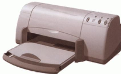
Digunakan untuk mencetak hasil komunikasi antara pengguna dengan CPU seperti yang nampak pada layar monitor ke dalam selembar kertas, bisa berupa tulisan atau gambar.
