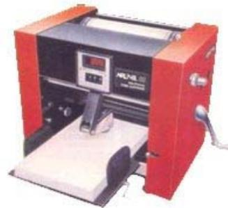
Ada 2 macam mesin stensil, yaitu : mesin stensil manual dan mesin stensil listrik. Terdapat pula model dengan bantalan-dasar, yang merupakan jenis duplikator stensil termurah dan memadai bila volume kerja yang harus dilakukan sedikit.
