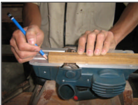
Gb. 5.1.169. Mengontrol Tinggi Pisau.
