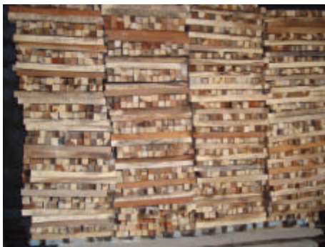
Gb. 3.15. Penyusunan Batang Kayu
