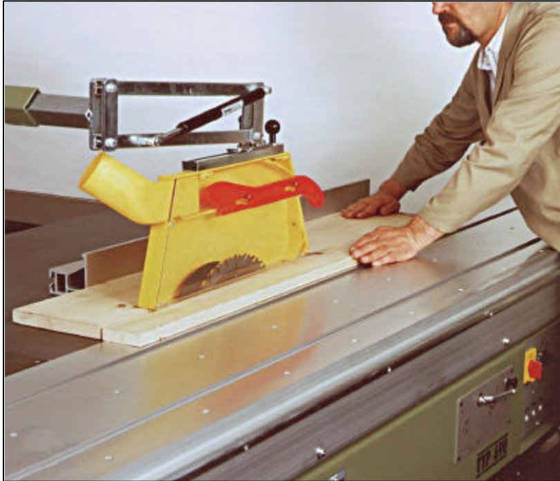
Gb. 1.5. Membelah Papan Menggunakan Mesin Gergaji
