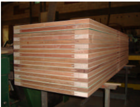
Gb. 3.17. Penyusunan Lembaran Daun Pintu
