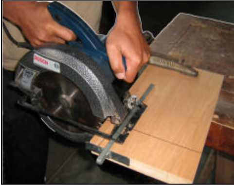
Gb.5.1.197: Memotong Dengan Pengantar
