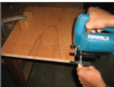
Gb.5.1.211: Memotong dengan Pengantar
