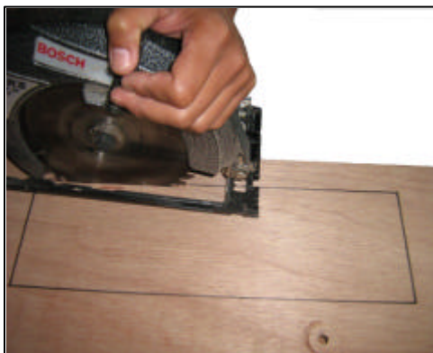
Gb.5.1.201: Memotong Lubang Buntu
