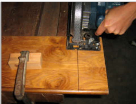
Gb.5.1.196: Memotong Tanpa Pengantar
