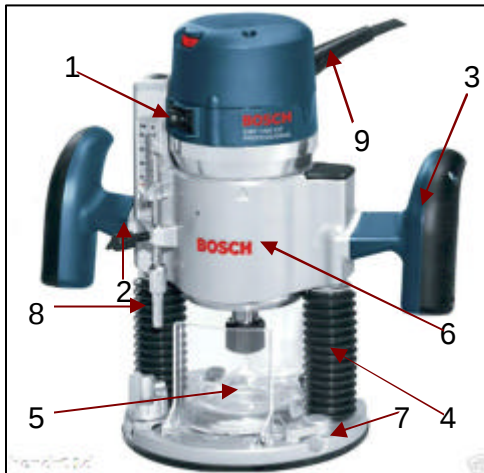
Gb.5.1.172 : Bagian Mesin Router
