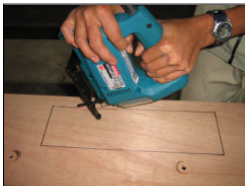
Gb.5.1.216: Memotong Lubang Buntu
