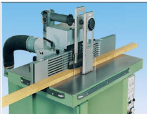
Gb.5.2.56: Mesin Frais dengan Pengaman Atas dan Samping
