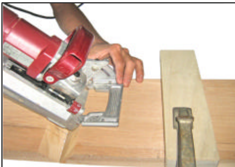
Gb. 5.1.158. Posisi Melubang Miring Sudut 45°.
