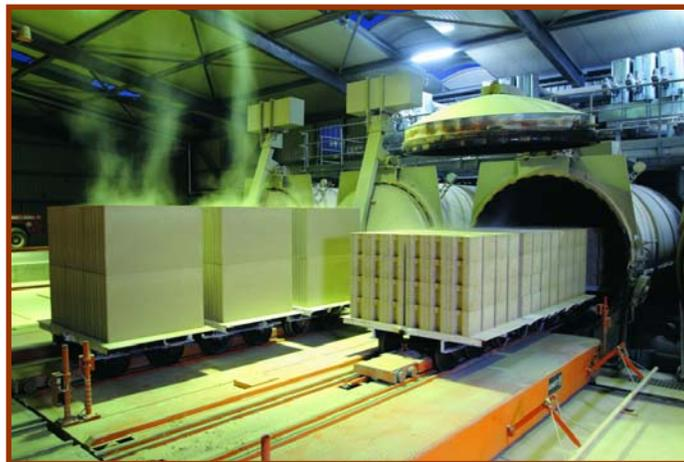
Gambar IV-10. Proses Pembuatan Bata Hebel
