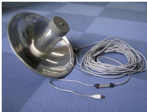
Gambar 2.10 Wajanbolic e-goen siap digunakan (Sumber: http://opensource.telkomspeedy.com/wiki )
