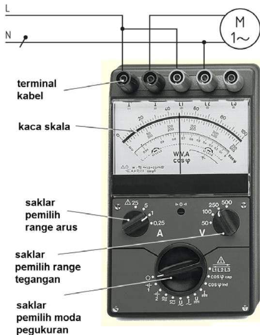
Gambar 8.18 : Pengawatan wattmeter dengan beban satu fasa
