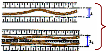
Gambar 4-135. Susunan struktur penanaman kabel tanah
