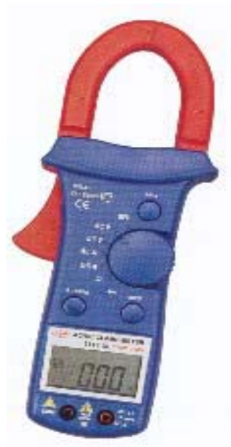
Gambar 4-100. Pengukuran dengan Tang Ground Tester Digital
