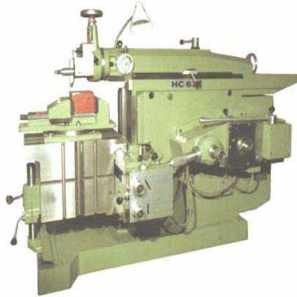
**Gambar 9 1. Mesin Sekrap datar atau horizontal (*shaper*).**
