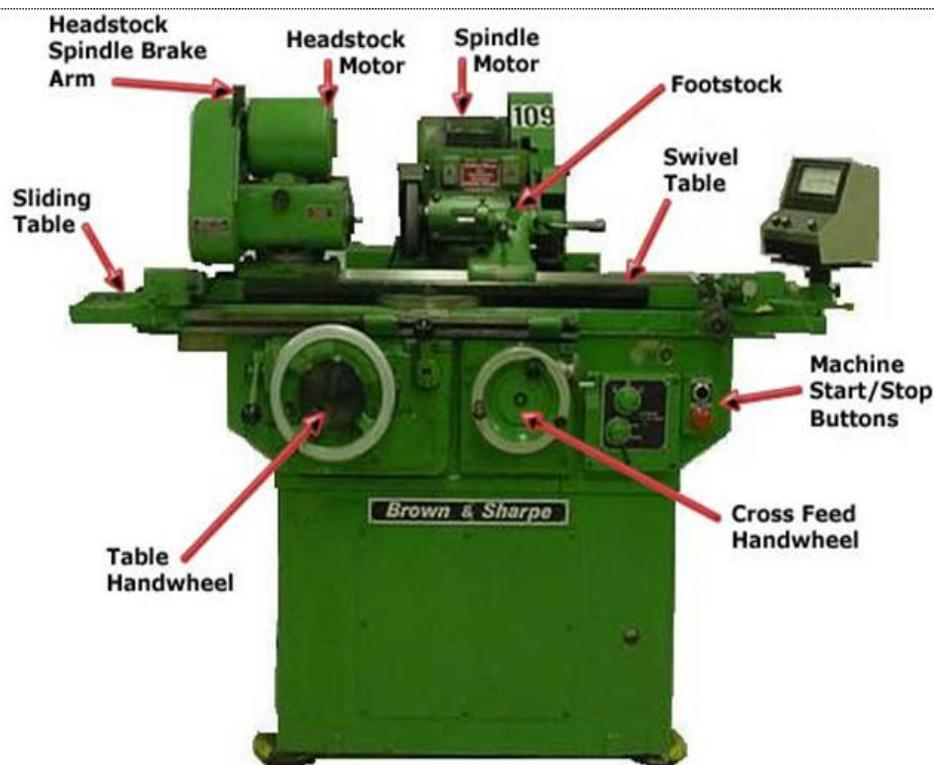
Gambar 10 1. Mesin Gerinda silindris.
