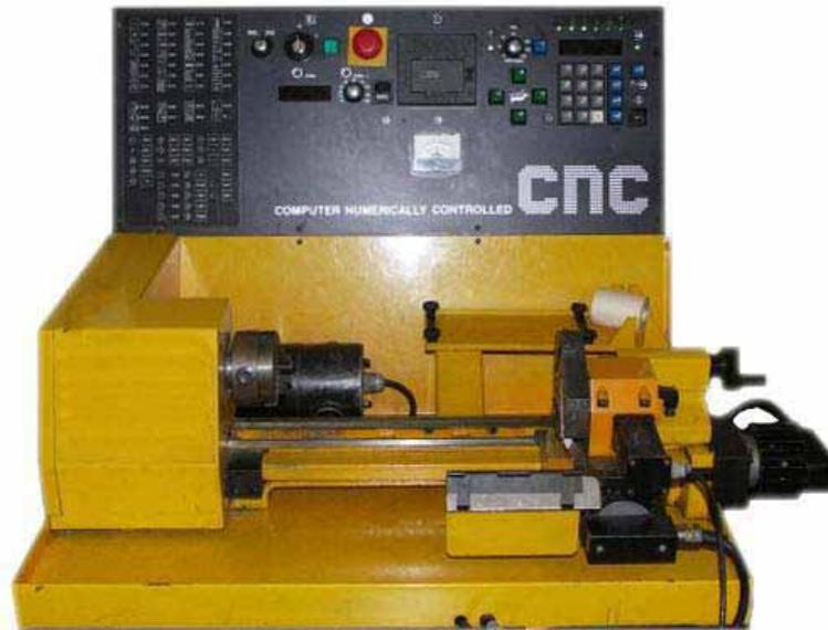
Gambar 12.2. Mesin Bubut CNC TU-2A
