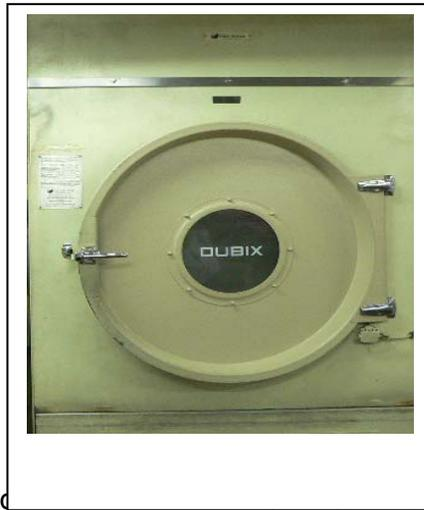
Mesin ini digunakan untuk mengeringkan pakaian yang sudah diperas. Proses pengeringan ini dilakukan dengan cara menghembuskan udara panas ke dalam drum mesin yang sedang berputar. Udara panas ini biasanya dihasilkan dari pembakaran gas, steam (uap panas) atau element electric.
