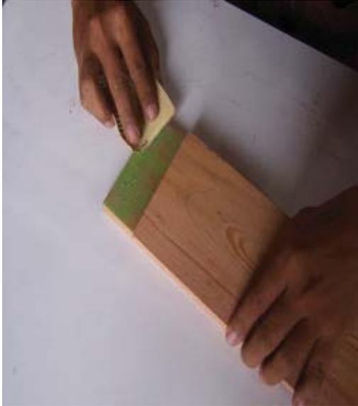
Amplas permukaan benda kerja hingga rata dengan kertas amplas nomor 180-240 dengan bantuan blok amplas kayu. Lakukan pekerjaan ini dengan teliti agar tidak ada permukaan benda kerja yang terlewatkan.
