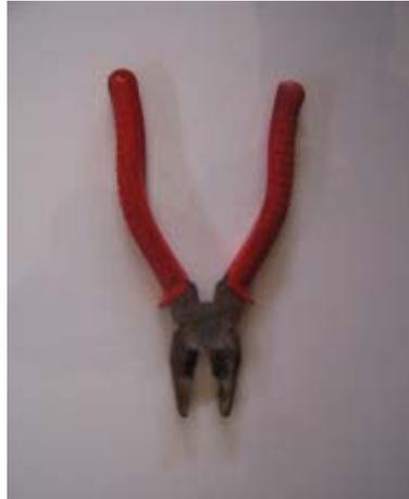
Tang terbuat dari Logam /Besi yang pada bagian pegangan dilapisi dengan karet plastik. Alat ini biasa digunakan untuk mengencangkan Sekrup dan juga untuk memotong mata gergaji yang terlalu panjang, atau memotong kawat dll.
