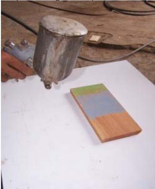
Langkah ini dilakukan agar permukaan benda kerja memperoleh lapisan yang rata dan halus. Pengolesan plamir dapat dilakukan dengan spray gun / pistol tabung tekan dengan tipis-tipis sampai rata.
