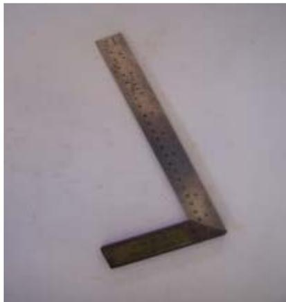
Siku-siku pada pekerjaan sekrol digunakan untuk mengukur / mengecek tegak lurus atau kemiringan mata gergaji terhadap meja kerja. Selain itu juga untuk mengecek hasil pemotongan bahan yang
