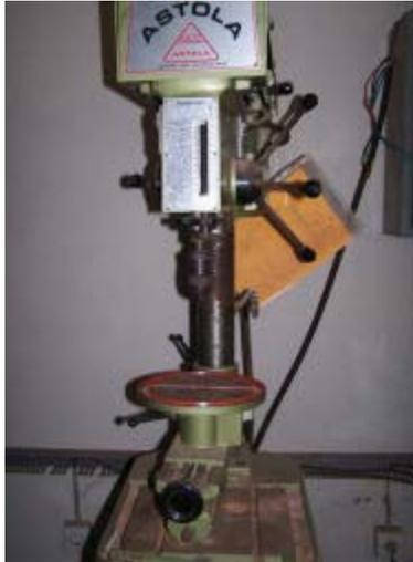
Bor adalah alat yang digunakan untuk membuat lubang yang akan di Sekrol.
