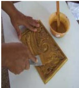
Pengisian pori-pori pada kayu bahan oker (kuas) dan dempul (skrap) dengan pelarut air. Atau gunakan filler dengan pelarut tinner
