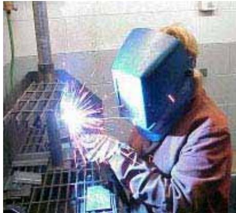
Gambar 8.1. Pekerjaan Mengelas menggunakan las busur nyala listrik
