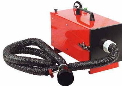
Gambar 7.36. Alat penghisap asap pengelasan
