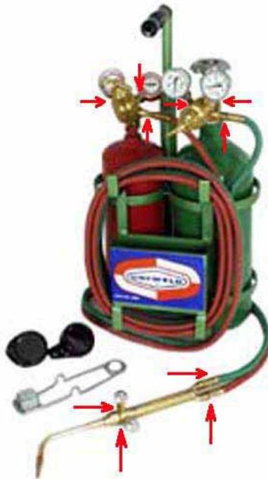
Gambar 7.37. Posisi Pemeriksaan Kebocoran Instalasi Las
