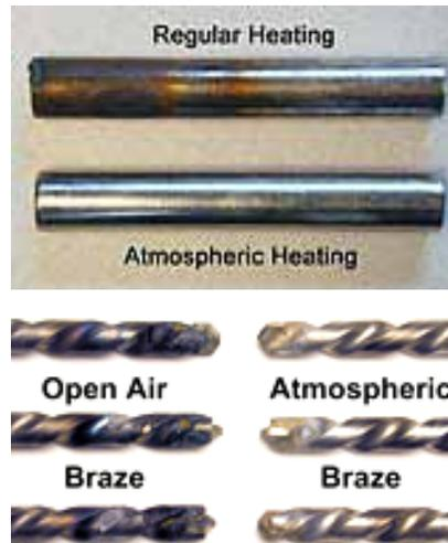
Gambar 9.12. Pematrian dengan Gas Pelindung
