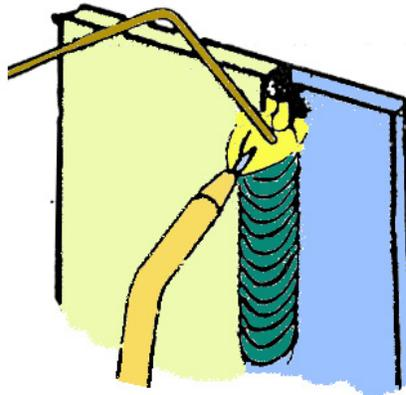
Gambar . 7.51. Mengakhiri jalur lasan pengelasan posisi vertikal
