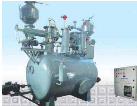
Gambar 7.2. Generator untuk Memproduksi Gas *Acetylene* dalam Tabung
