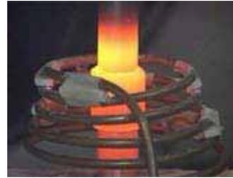
Gambar 9.28. Pematrian komponen Baja Metode Kumparan Induksi di dalam Ruang Pemanas dengan Gas Argon
