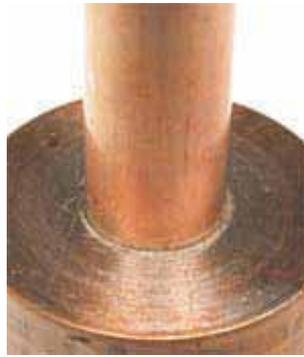
Gambar 9.24. Contoh Sambungan Hasil Pekerjaan Pematrian Keras
