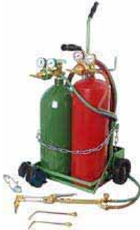
Gambar 7.26. Instalasi Peralatan Las *Oxy-acetylene* Portabel
