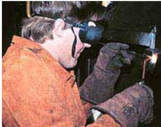
Gambar 7.1. Pekerjaan mengelas dengan *oxy-acetylene*
