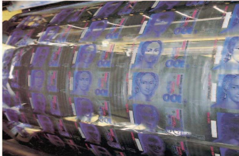
Gambar 7.63. Master cetakan (dengan 4 warna tinta) pada silinder gravure untuk mencetak uang kertas
