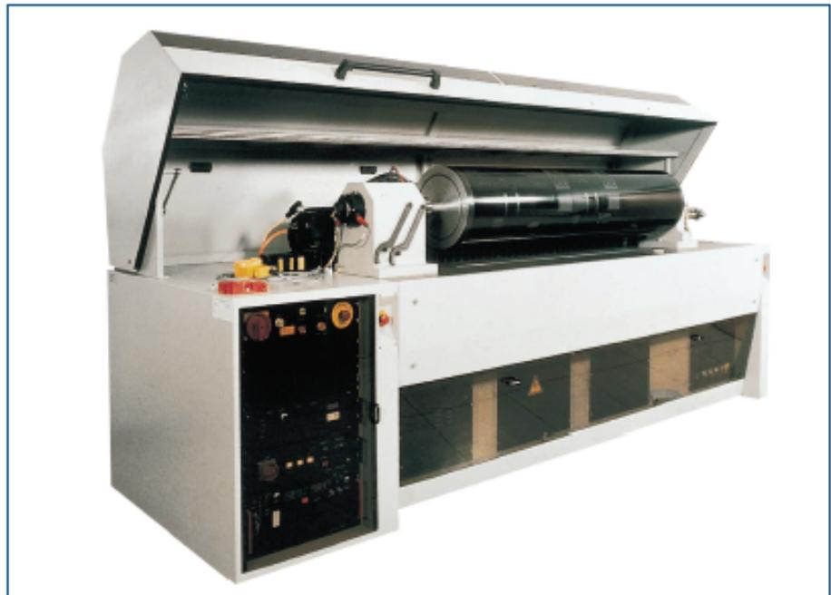
Gambar 6.16. CtP fleksografi uk.1067mm x 1524mm (Cyrel Digital Imager, ThermoFlex 2630 dan ThermoFlex 2630V untuk mesin cetak flekso
