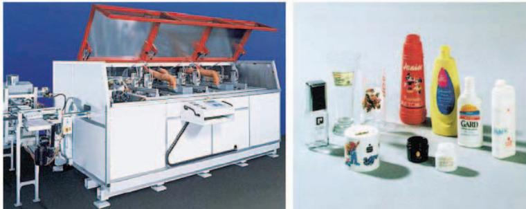
Gambar 7.144. Mesin sablon otomatis untuk botol, gelas, dll. dan
