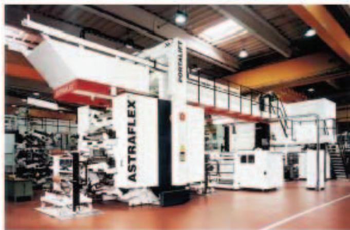
Gambar 7.44. Mesin cetak fleksografi dengan silinder tekan terpusat dengan 8 unit cetak dengan keotomatisan tingkat tinggi (Astraflex, W&H)
