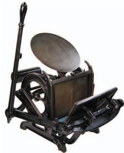
Gambar 7.6. Hand Press dengan Sistem Penintaan Piring
