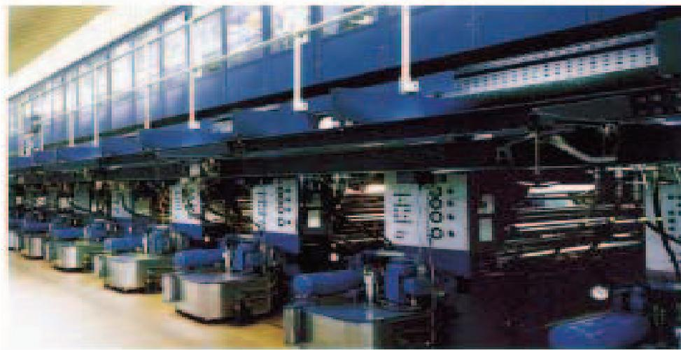
Gambar 7.74. Mesin Cetak Rotogravure dengan cadangan tinta pada tangki penyuplai di bagian depan (KBA)
