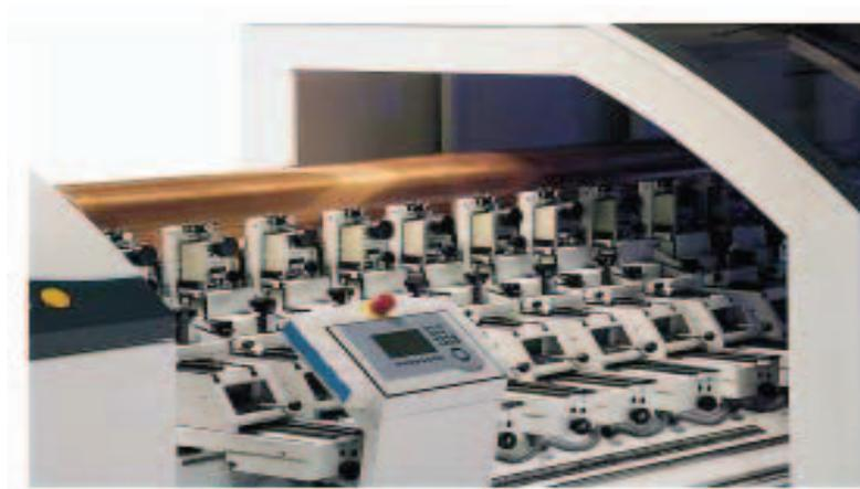
Gambar 7.60. Mesin Pembuat Acuan untuk Mesin Rotogravure (Helio Klischograph K 406-Sprint, Hell Gravure System)
