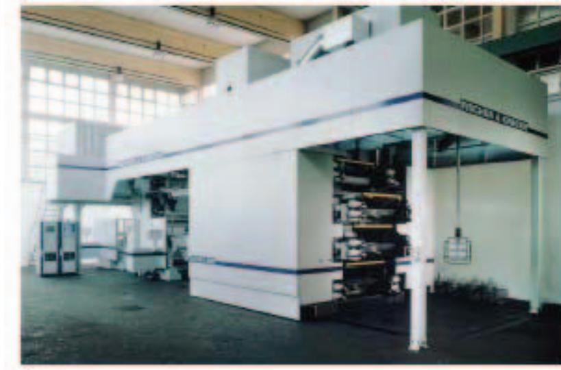
Gbr. 7.41. Mesin cetak flekso 8 warna dengan silinder tekan tepusat (34 DF/8-CNC, Fischer & Krecke)
