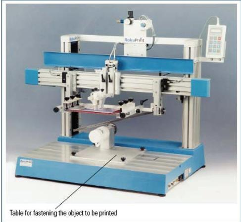
Gambar 7.143. Mesin sablon semi otomatis untuk permukaan bidang lengkung
