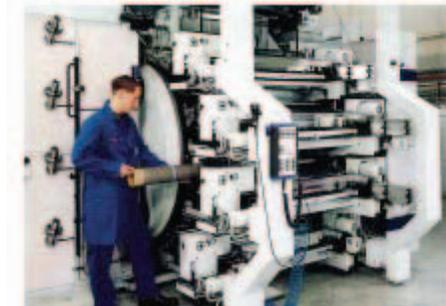
Gambar 7.43. Penggantian lapisan silinder pelat pada mesin fleksografi (Fischer & Krecke)
