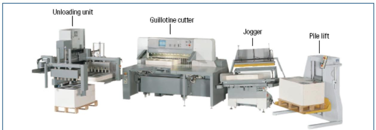
Gambar 8.53. Kelengkapan unit pemotongan (cutting line)
