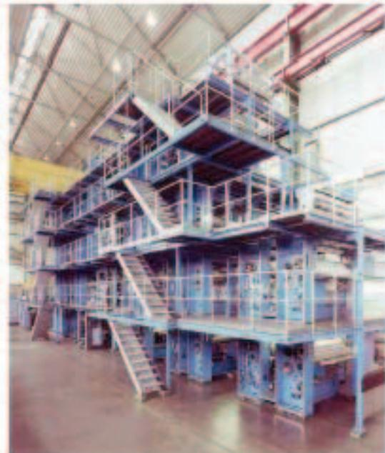
Gambar 7.50. Skema mesin cetak fleksografi desain tipe susun/tumpuk
