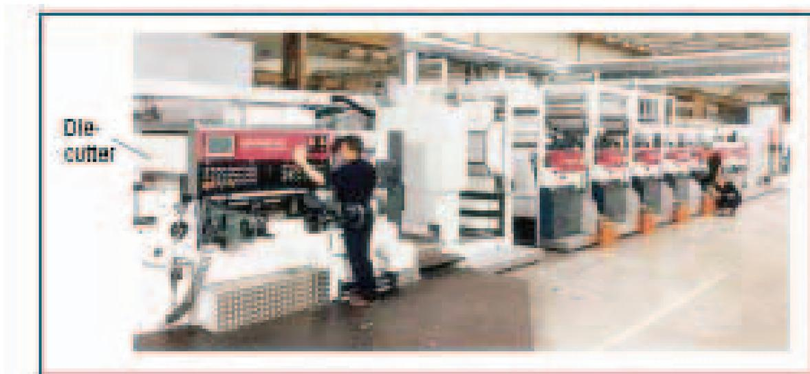
Gambar 7.46. Mesin cetak fleksografi desain satu garis terintegrasi dengan unit pemotong dan unit lipat (Lemanic 82, Bobst)
