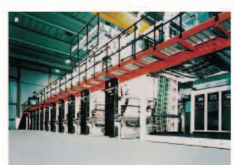
Gambar 7.75a. Mesin Rotogravure dengan 10 unit cetak (Heliostar 2000, W&H)
