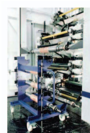
Gambar 7.42. Penggantian lapisan silinder pelat dengan proses silinder otomatis pada mesin flekso dengan silinder tekan ternusat (Fischer & Krecke)
