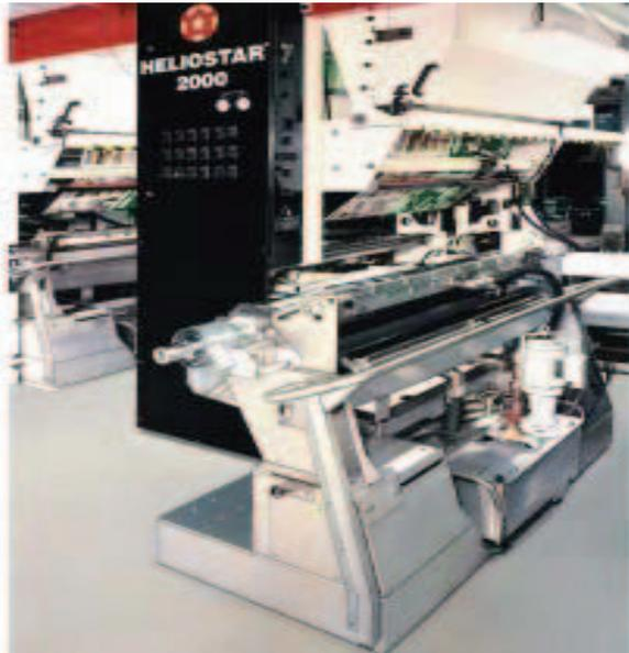
Gambar 7.68. Mesin rotogravure yang dilengkapi peralatan bantu untuk penggantian lapisan silinder gravure dan unit penintaan untuk mempercepat proses pengangantiannya (W&H)
