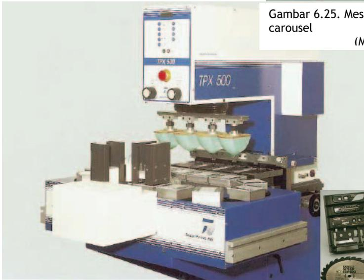
Gambar 6.26. Mesin cetak Pad 4 warna (TPX 500, Teca Print)
