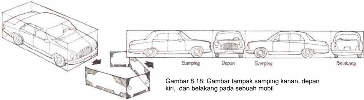
Gambar 8.18: Gambar tampak samping kanan, depan kiri, dan belakang pada sebuah mobil
