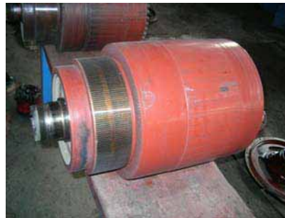
Gambar 8.26. Rotor Traksi Motor
