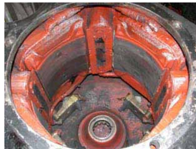
Gambar 8.25. Stator Traksi Motor
