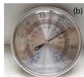
Gambar 7.6 (a) Saat dipanaskan, bimetal melengkung. (b) Termometer bimetal, digunakan untuk pengukur suhu
