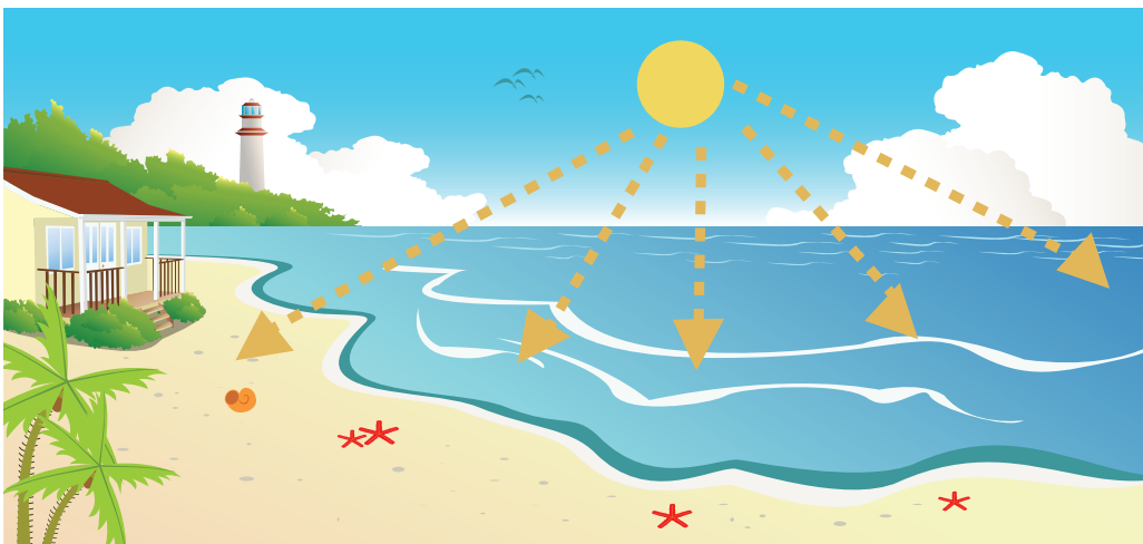
Gambar 8.20 Kalor berpindah dari matahari hingga sampai ke bumi dengan melalui ruang hampa. Karena tidak ada zat perantara, perpindahan kalor tersebut tidak mungkin secara konduksi atau konveksi.
