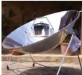
Gambar 8.25 Kompur surya. Tandai di mana masakan dimasak. Mengapa permukaan pemantul panas matahari mengkilap? Mengapa melengkung?
