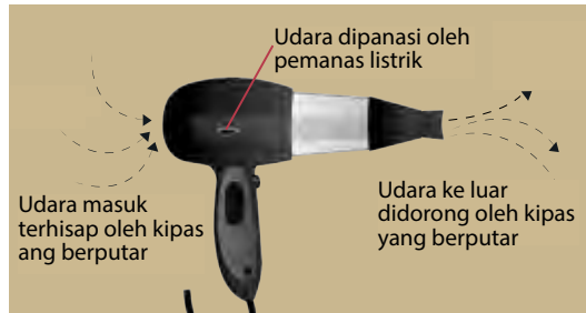
Gambar 8.19 Konveksi pada pengering rambut
