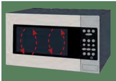
Gambar 8.18 Konveksi pada oven
