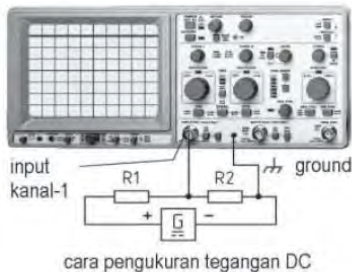
Gambar 9.3 Cara Pengukuran Tegangan DC
