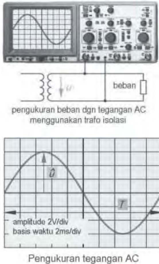
Gambar 9.4 Cara Pengukuran Tegangan AC
