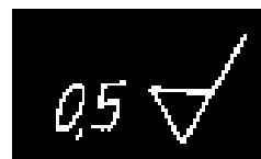
Gambar 135. Kelebihan ukuran untuk proses lanjutan
