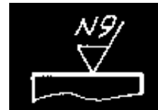
Gambar 131. Lambang pengerjaan dengan mesin
