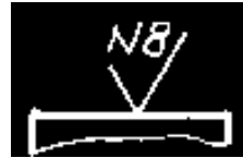
Gambar 130. Lambang pengerjaan untuk semua proses
