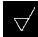
Gambar 128. Tanda pengerjaan dengan penyayatan
