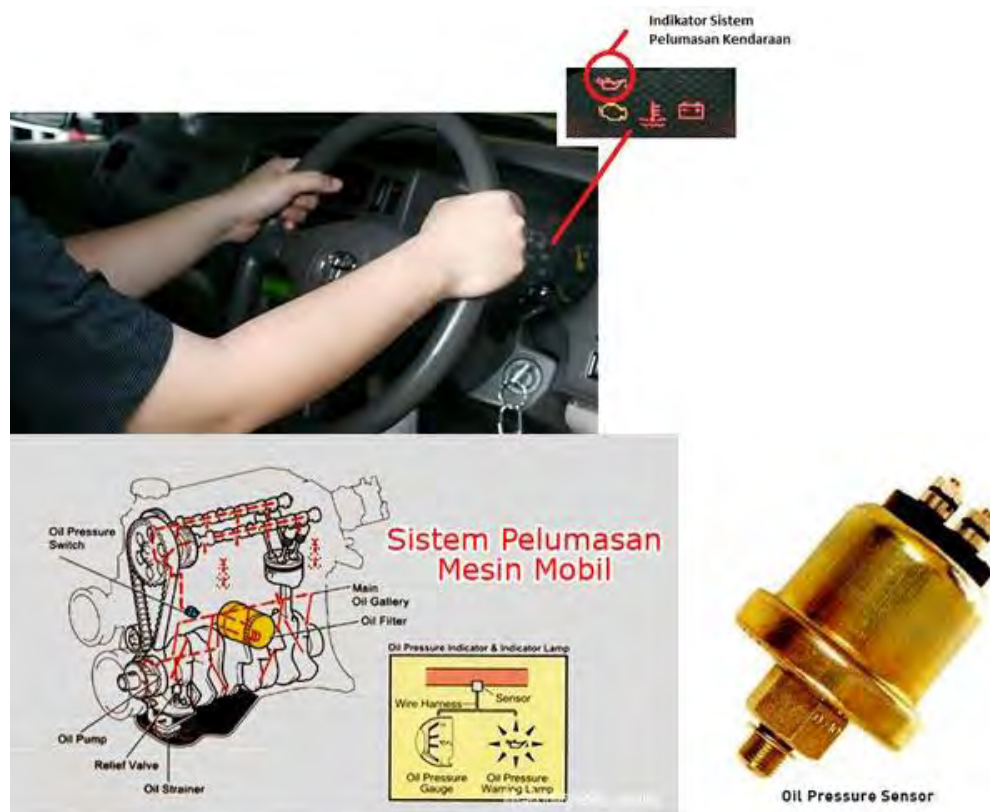
Gambar 2.2 Sistem pelumasan kendaraan dan indikator kerjanya
