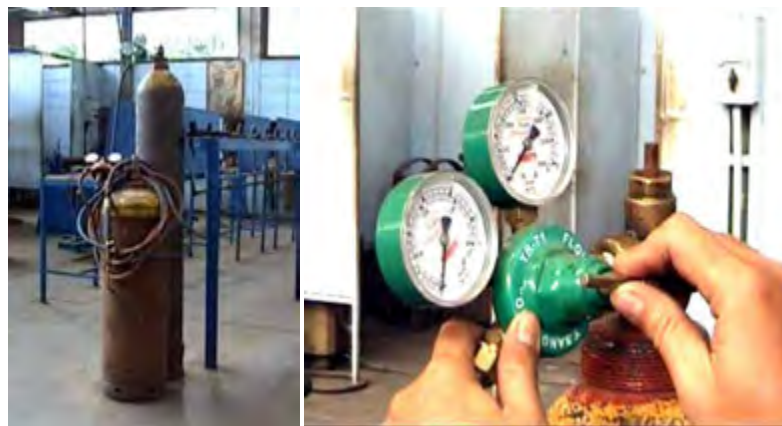
Gambar 2.1 Perlengkapan Las Asetilena Dilengkapi Regulator Pressure gauge
