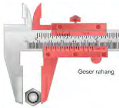
Gambar 3.21 Mengukur Diameter Luar Benda
