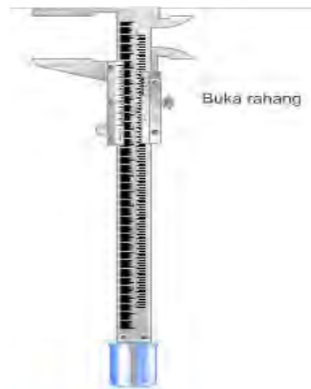
Gambar 3.23 Mengukur Kedalaman Benda
