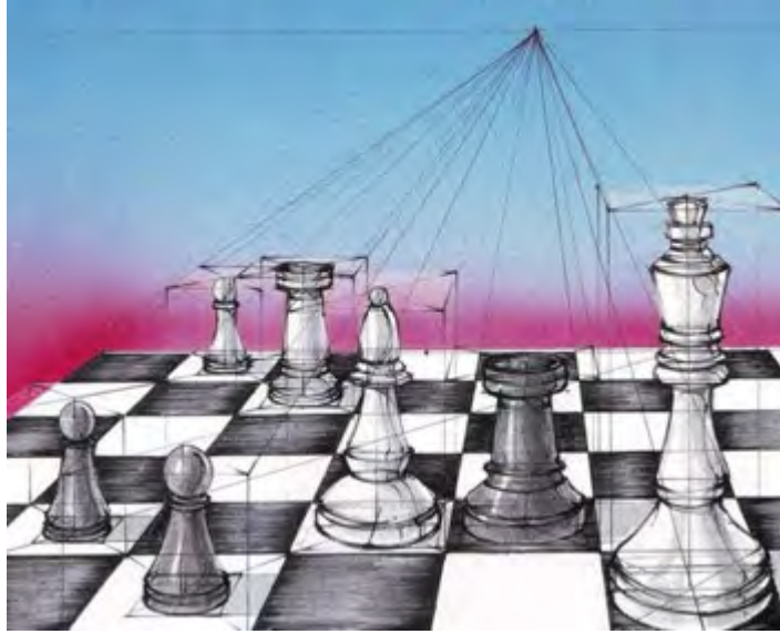
Gambar 263. Gambar perspektif satu titik lenyap Sumber: Buku "Drawing In Perspective"
