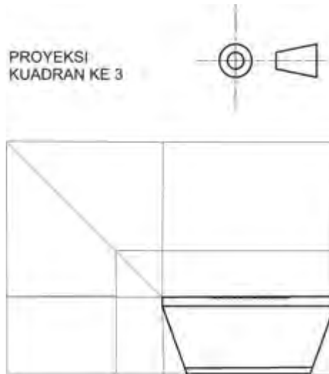
Gambar 248. Menempatkan tampak depan pada lay out proyeksi kuadran ke 3 Sumber: Foto Banu Arsana
