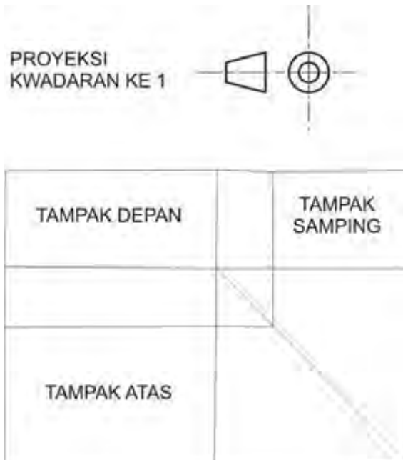
Gambar 258. Lay out penempatan gambar tampak kuadran pertama Sumber: Foto Banu Arsana
