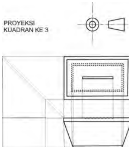
Gambar 249. Menarik garis-garis proyeksi dari tampak depan ke atas untuk mendapatkan gambar tampak atas Sumber: Foto Banu Arsana
