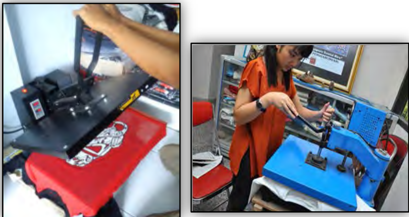
Gambar 2.53. Cara menggunakan alat press (Foto. Koleksi pribadi)
