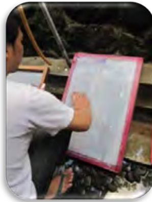
Gambar. 3.5 Penghapusan gambar pada screen (Sumber: Koleksi foto pribadi, 2013)
