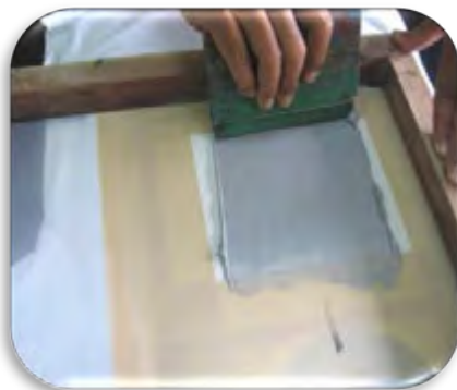
Gambar: 3.26. Penyablonan warna pertama (Sumber: Koleksi foto sendiri, 2009)
