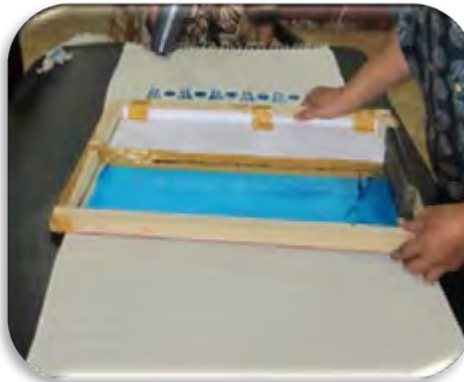
Gambar 1.14. Meletakkan screen pada media yang di sablon (Sumber: Koleksi Foto Pribadi, 2013)
