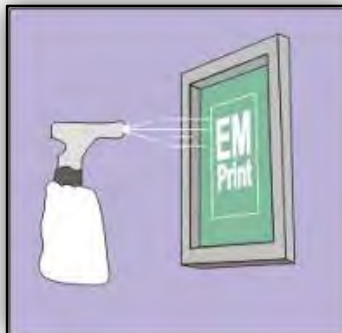
Gambar 2.38. Penggunaan hand spreyer pada screen Setelah afdruk (Foto. Google com)
