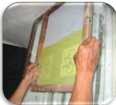
Gambar: 3.19. Melepas perangkat afdruk (Sumber: Koleksi foto sendiri, 2009)
