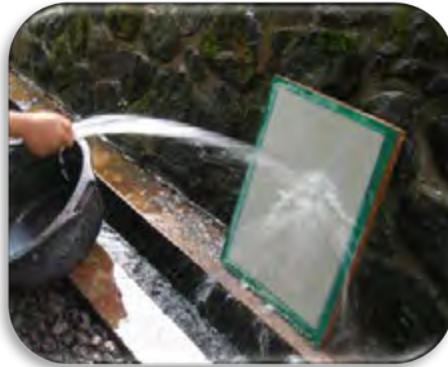
Gambar 1.22. Menghapus gambar pada screen (Sumber: Koleksi foto pribadi, 2013)
