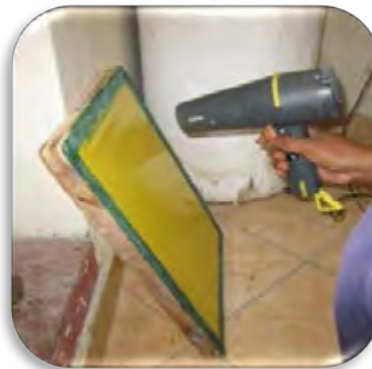
Gambar: 3.17. Pengeringan pengolesan obat peka caahaya (Sumber: Koleksi foto sendiri, 2013)
