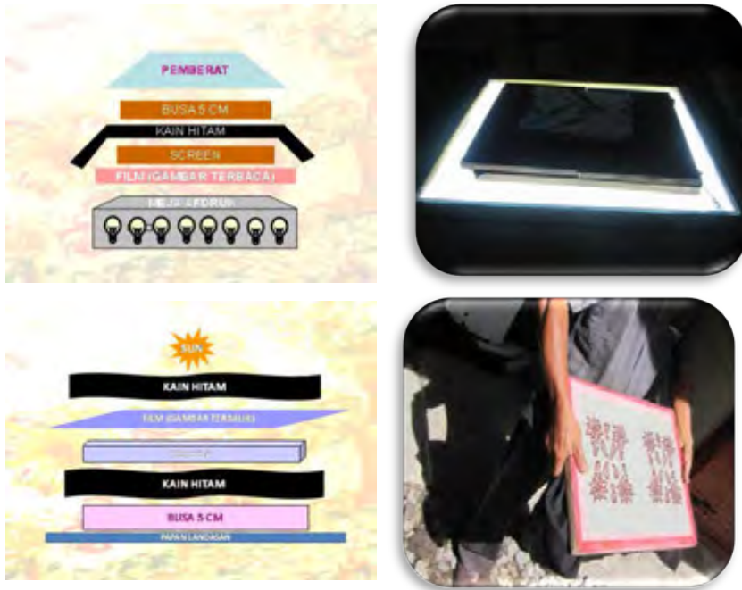
Gambar.3.3. Poses pembuatan fim negatif (Sumber: Koleksi pribadi, 2013)
