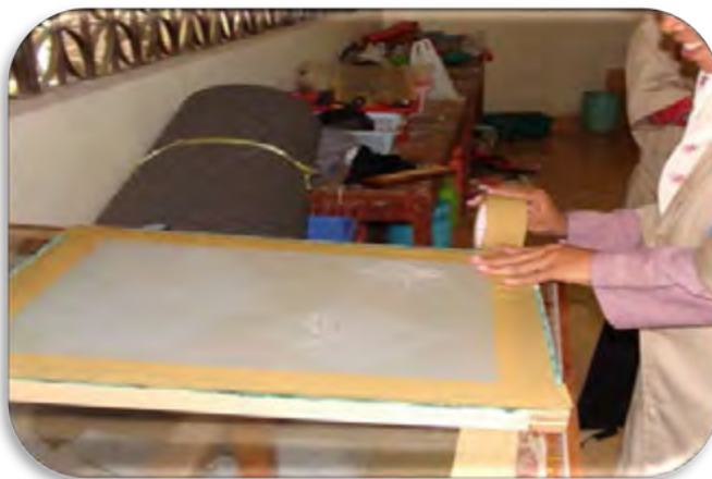
Gambar: 3.23. Melapsi screen dengan lakband (Sumber: Koleksi foto sendiri, 2009)
