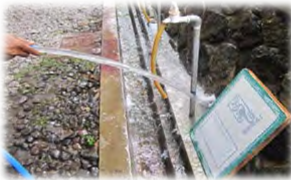
Gambar 1.11. Penyemprotan Screen setelah afdruk (Sumber: Koleksi Foto Pribadi, 2013)
