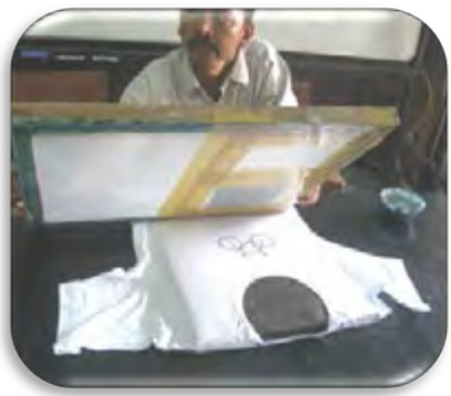
Gambar: 3.26. Penyablonan warna pertama (Sumber: Koleksi foto sendiri, 2009)
