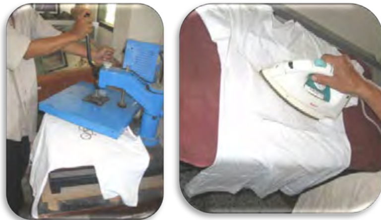
Gambar: 3.30. Fiksasi dengan setrika dan mesin press (Sumber: Koleksi foto sendiri, 2009)
