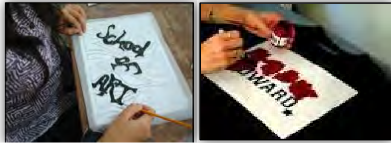
Gambar 2.27. Penggunaan rapido, tinta cina dan tinta opaque saat membuat film diapositif (Foto. Koleksi pribadi)
