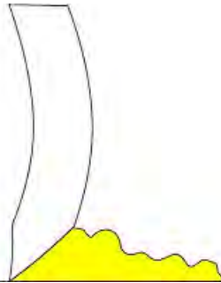
Gambar 2.49. Raket melengkung karena terlalu ditekan (Foto. http://kaospolosAndalas.com )
