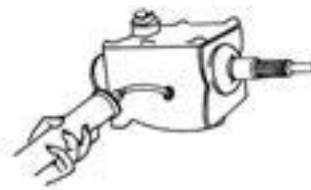
Gambar 4.35. Pengisian Oli Transmisi
