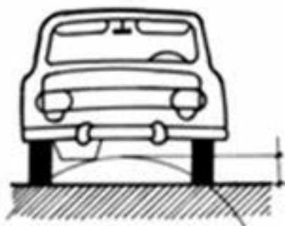
Gambar 6.6. Jarak bebas kendaraan antar bagian kendaraan terendah dengan permukaan jalan.
