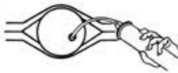
Gambar 4.68. Pengisian Oli pada Penggerak Aksel
