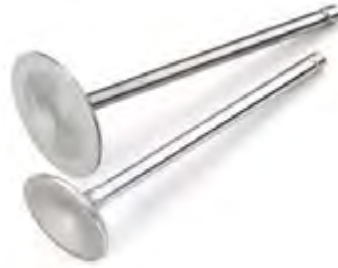
Gambar 13. Katup masuk dan katup buang.
