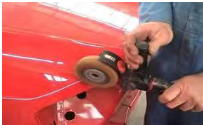
Gb.1.55. Penggunaan alat rubber wheel untuk membersihkan sisa-sisa potongan pinstrip
