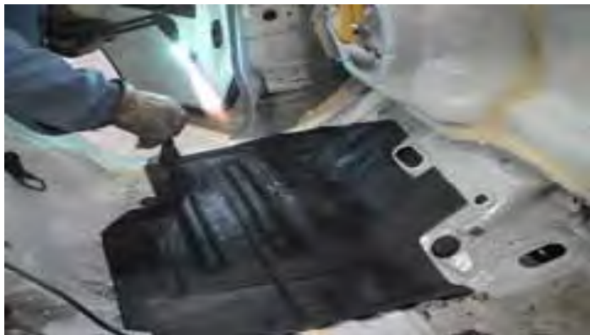
Gb.4.31. Pemotongan tepian/ujung material peredam suara
