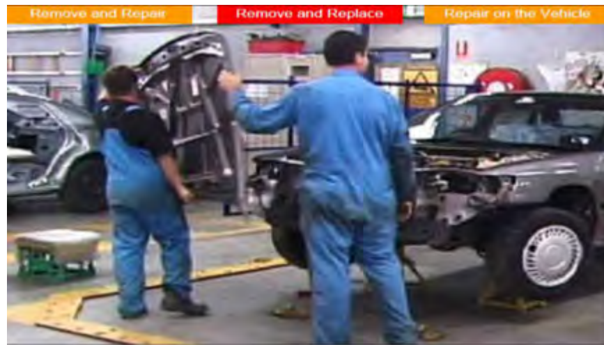
Gb.1.12. Pelepasan bonnet (kap mesin)
