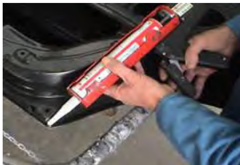
Gb.4.14. Pelapisan sealer sepanjang bidang pengelasan
