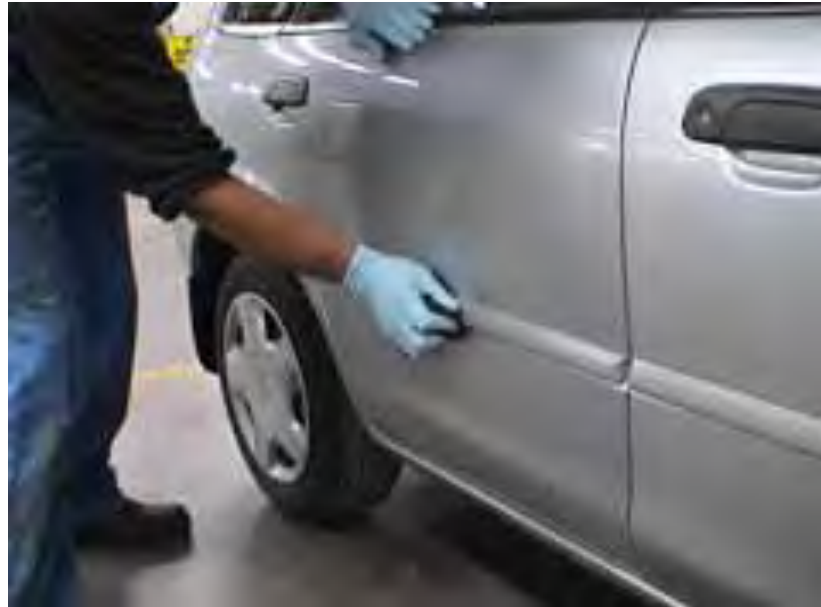
Gb.2.42. Perekatan moulding tersebut dengan cara memberi tekanan dengan menggunakan telapak tangan secara berurutan
