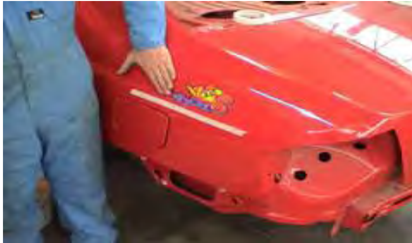
Gb.2.53. Pemeriksaan permukaan decal terhadap kemungkinan terdapat gelembung udara yang terjebak di bawah permukaan decal
