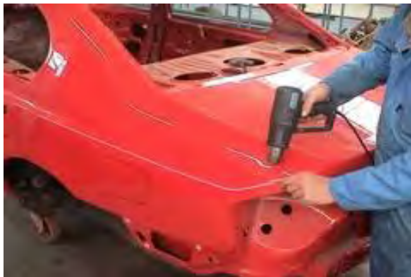
Gb.1.53. Pengangkatan salah satu ujung dari pinstrip dengan menggunakan kuku jari
