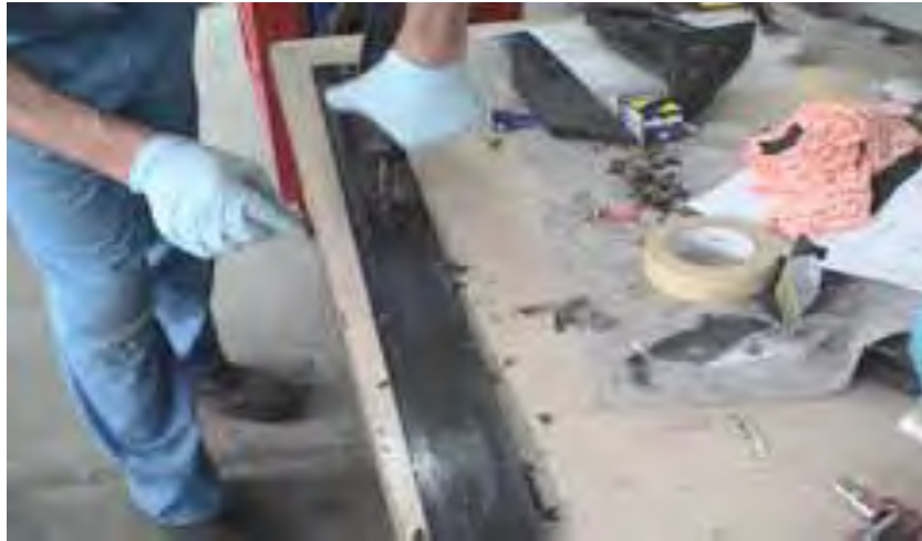
Gb.2.26. Pembersihan lem yang tersisa dengan menggunakan cairan pelarut prepsol
