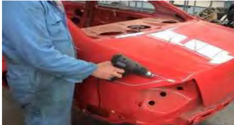
Gb.1.52. Pemanasan pinstrip dengan menggunakan heat gun
