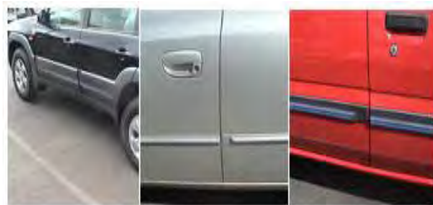
Gb.1.19. Jenis-jenis moulding; dari kiri ke kanan : wide moulding, narrow moulding dan recessed moulding.
