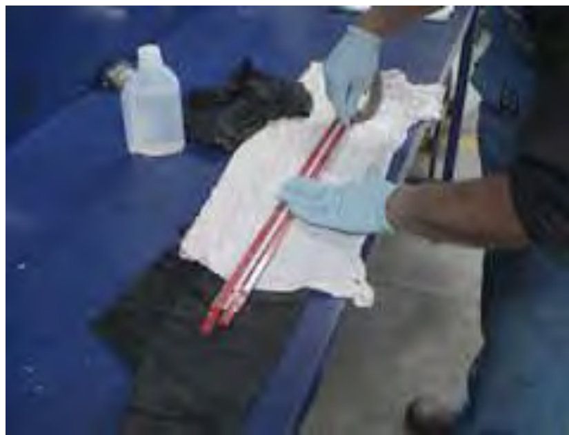
Gb.2.31. Pemasangan pita perekat khusus pada moulding
