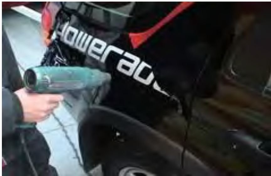
Gb.1.48. Pemanasan permukaan wrap menggunakan heat gun
