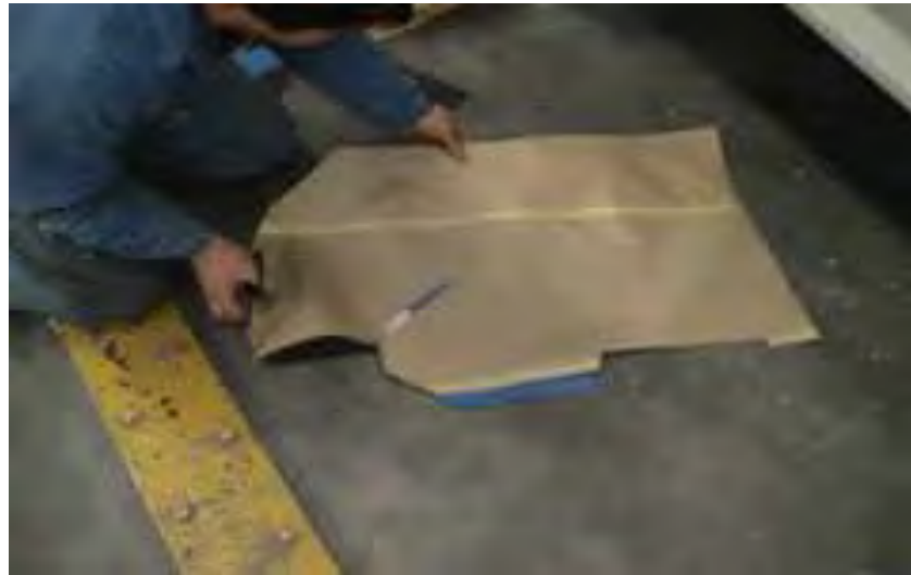
Gb.4.27. Pemotongan lembar peredam suara
