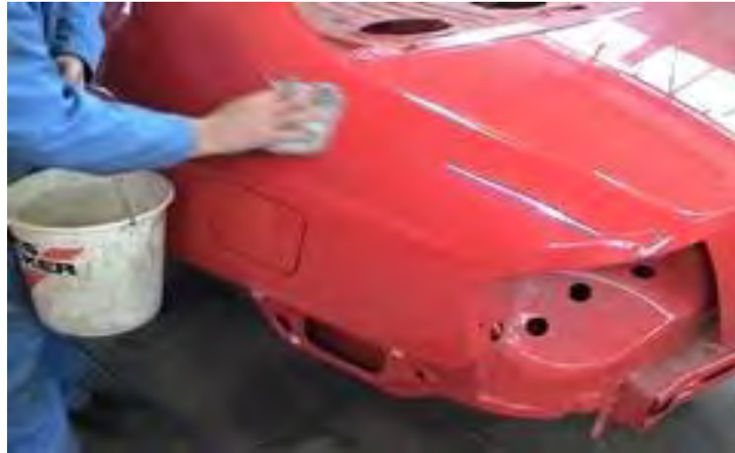
Gb.1.56. Pembersihan sisa lem pinstrip dengan menggunakan cairan pelarut (solvent)
