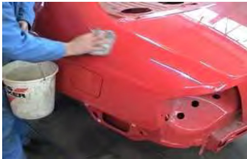
Gb.1.46. Pembersihan sisa lem decal dengan menggunakan cairan pelarut (solvent)
