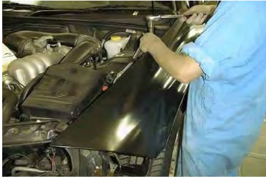
Gb.2.14. Pemasangan kembali pelindung (guard) yang baru
