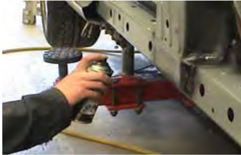
Gb.4.43. Pelapisan zinc primer coating dari kaleng aerosol
