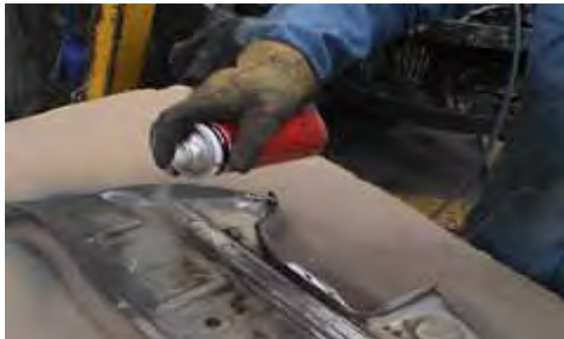
Gb.4.42. Pelapisan zinc primer coating pada join dan seam panel bodi
