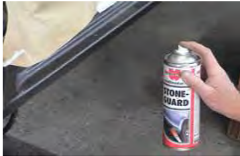
Gb.4.39. Pelapisan bidang yang kecil menggunakan cat kaleng aerosol
