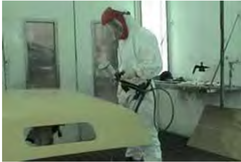
Gb.3.4. Pengecatan pada panel bodi kendaraan
