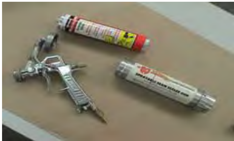
Gb.4.46. spray-on sealant diaplikasikan menggunakan sprayer udara
