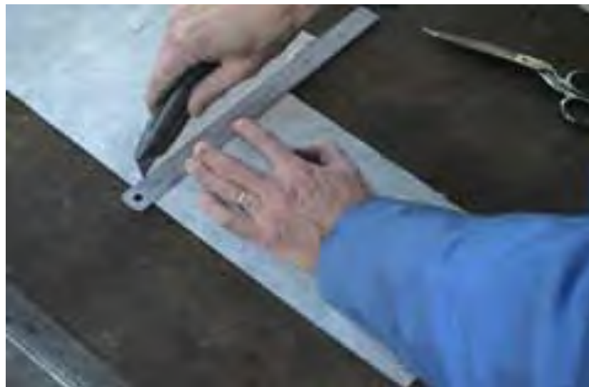
Gb.4.23. Pemotongan lembar peredam suara
