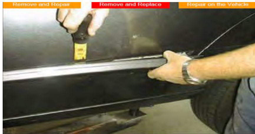
Gb.1.15. Pelepasan moulding
