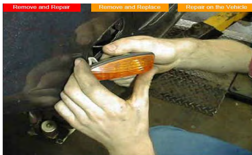
Gb.1.14. Pelepasan lampu-lampu dan kelistrikan bodi
