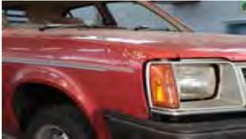
Gb.1.39. Pinstrip untuk memperjelas dan mempertegas bentuk lekukan atau kontur bodi kendaraan
