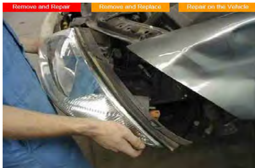
Gb.1.10. Pelepasan rangkaian lampu kepala
