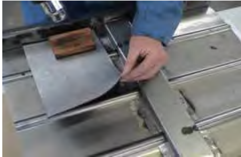
Gb.4.25. Pemasangan lembaran peredam suara
