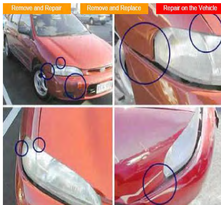
Gb.2.16. Pemeriksaan kerusakan pada pelindung (guard).
