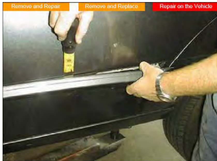
Gb.2.20. Pelepasan moulding
