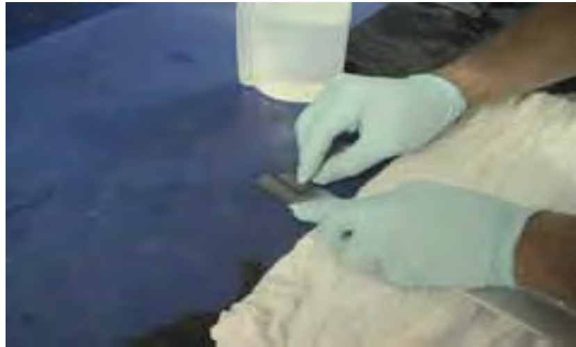
Gb.2.34. Pemotongan dan perapian ujung pita perekat
