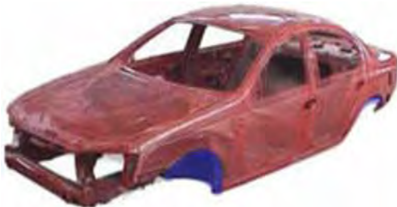
Gb.4.45. Daerah penggunaan spray-on sealant (warna biru terang)
