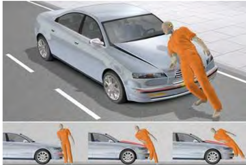
Gb.1.2. Fungsi guard sebagai pelindung keselamatan pejalan kaki.
