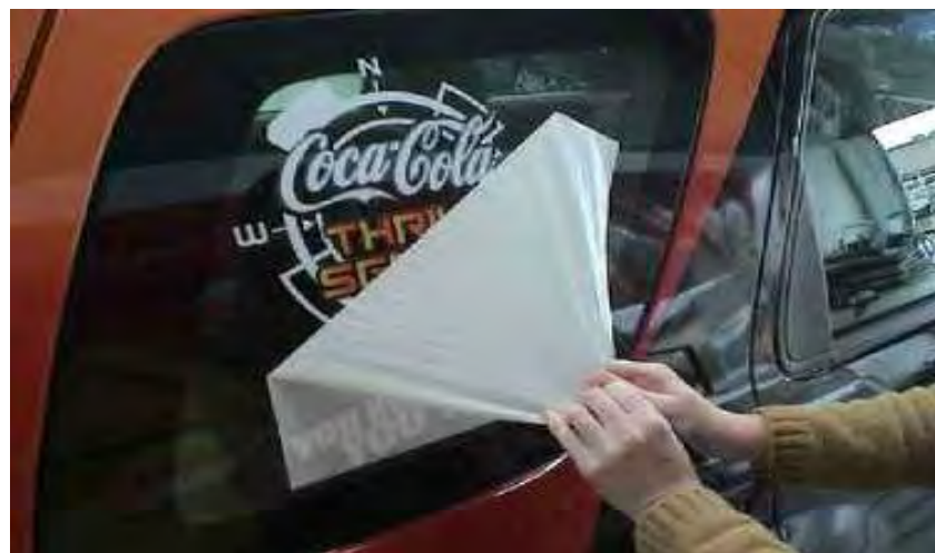
Gb.2.62. Pelepasan kertas transfer dari permukaan decal
