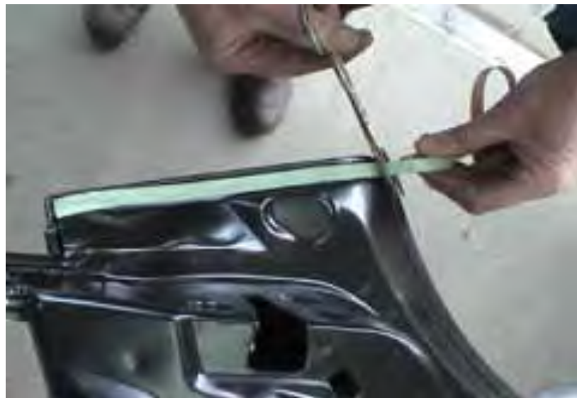
Gb.4.6. Pemotongan pita perekat
