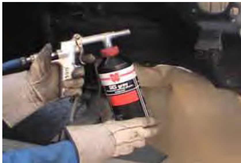
Gb.4.38. Anti-chipping paint diaplikasikan menggunakan sprayer udara
