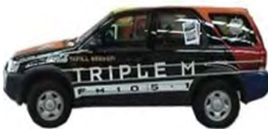
Gb.1.47. Bodi kendaraan yang menggunakan wrap (decal berukuran besar)
