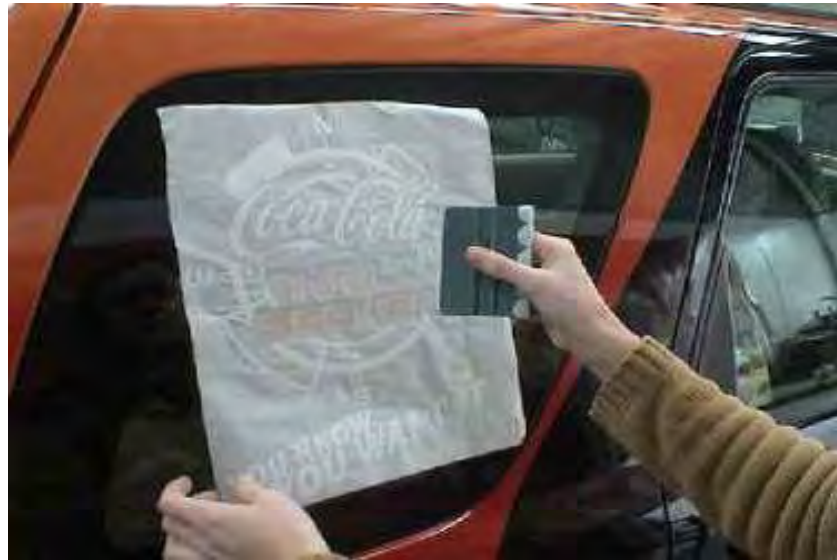
Gb.2.61. Penempelan decal pada permukaan kaca kendaraan
