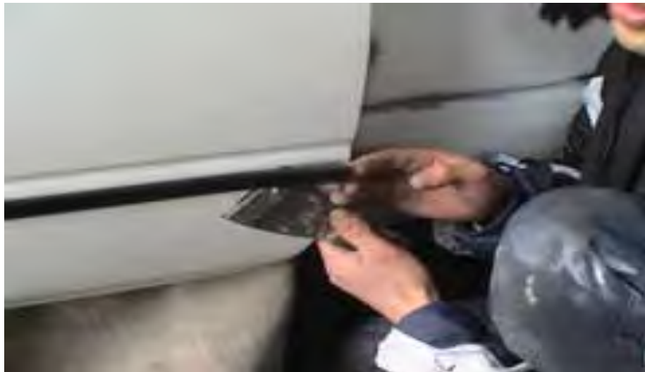
Gb.1.30. Penggunaan kapi/skrap untuk mengungkit moulding
