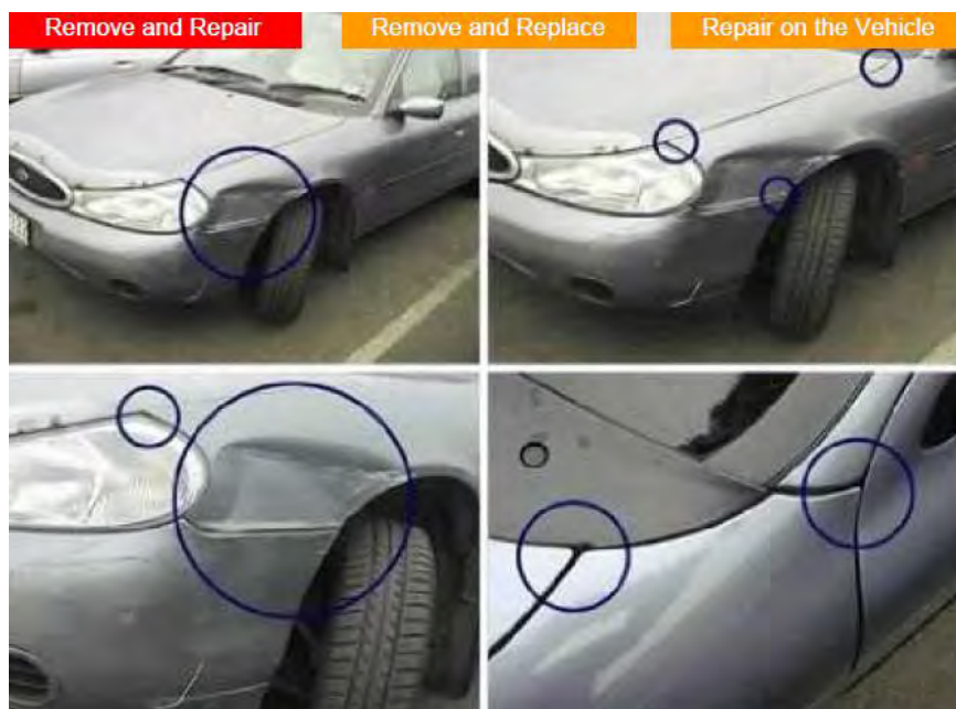
Gb.1.7. Pemeriksaan pelindung (guard) terhadap kerusakan yang terjadi
