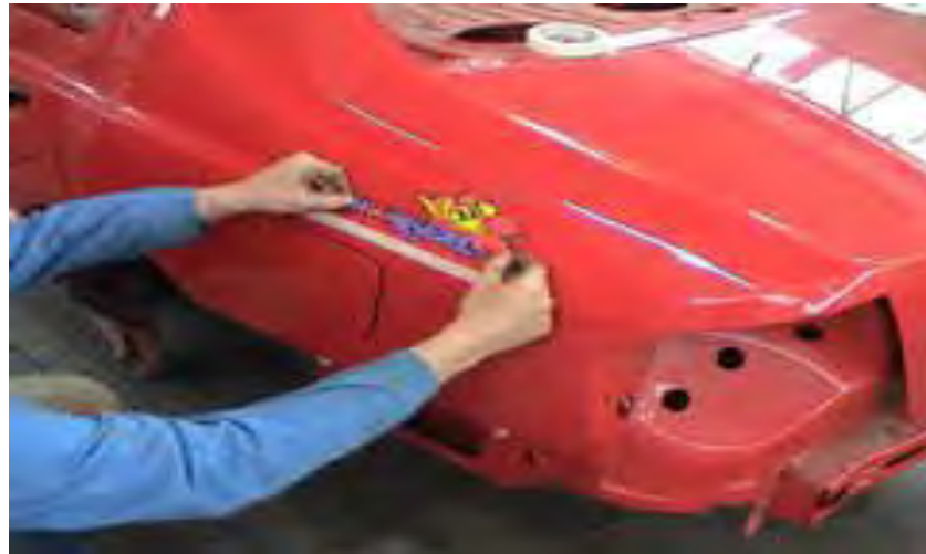
Gb.2.51. Pemasangan decal di tempat yang telah ditandai dengan masking tape
