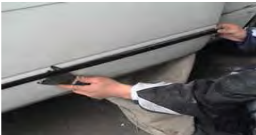
Gb.1.32. Pelepasan klip dari panel dan pelepasan moulding
