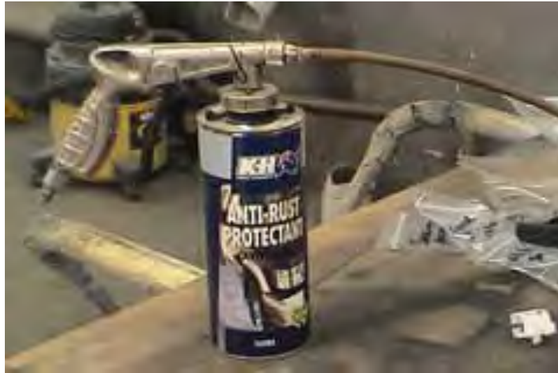
Gb.4.34. Cavity wax diaplikasikan menggunakan sprayer udara
