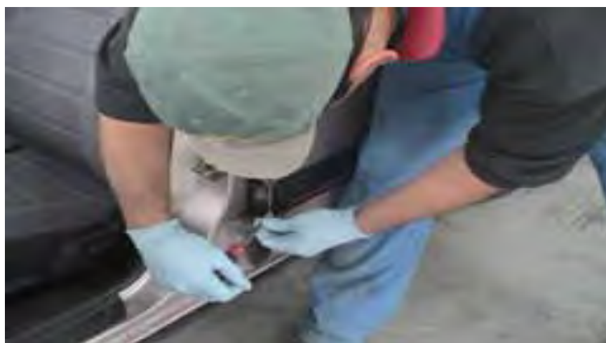
Gb.1.34. Penggunaan obeng yang telah diberikan masking tape sebagai pengungkit moulding
