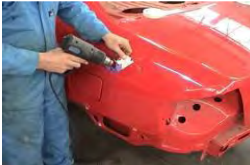
Gb.1.45. Pelepasan decal dari bodi kendaraan
