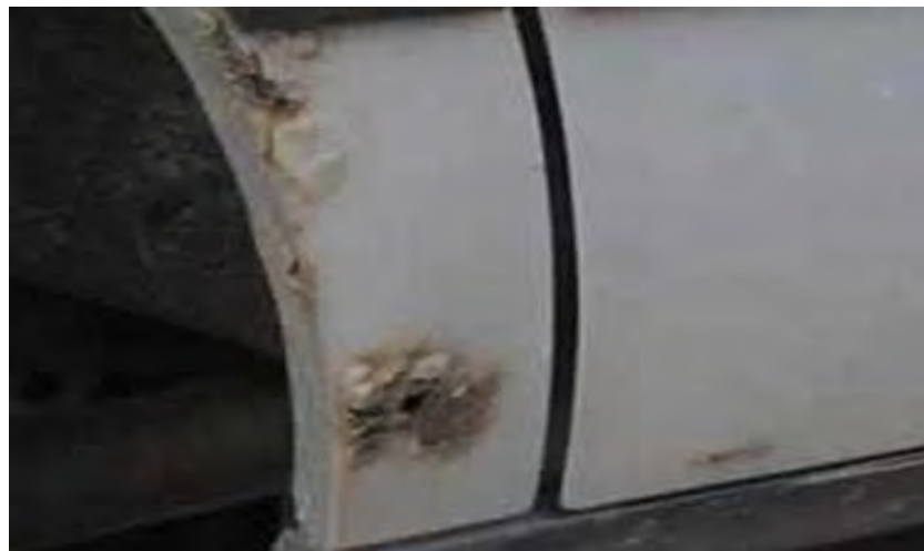
Gb.3.1. Korosi pada logam besi atau baja dari panel bodi
