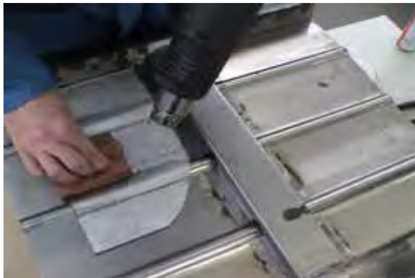
Gb.4.26. Pemanasan permukaan menggunakan heat gun
