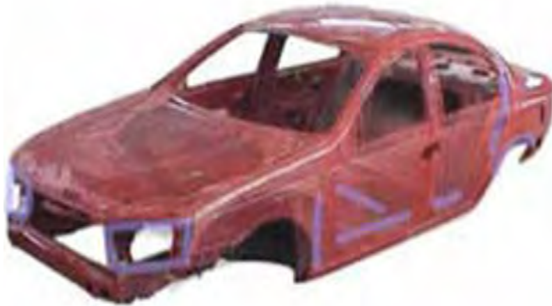
Gb.4.9. Daerah pemasangan joint and seam sealer (warna ungu)
