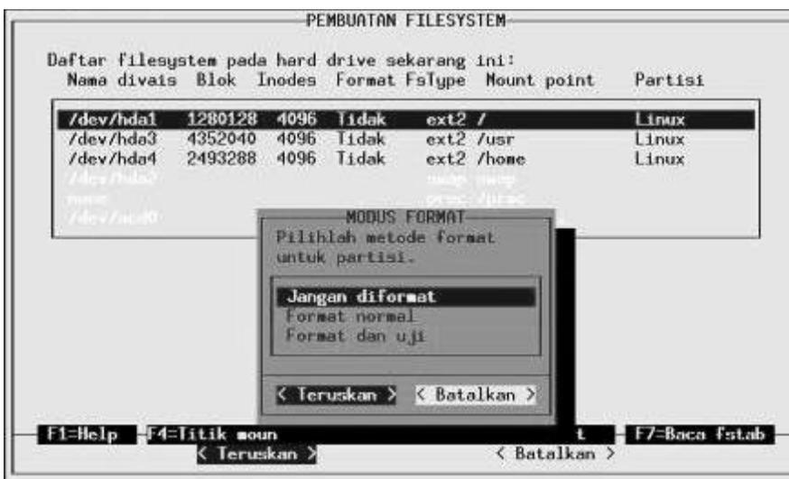
Gambar 4.15 Menentukan proses format
