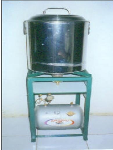
Perebusan filtrat adalah proses yang dilakukan untuk mendapatkan filtrat yang kental. Filtrat yang telah disaring, direbus kembali dengan penambahan KCl selama 15 menit dan terus diaduk pada suhu perebusan  $60^{\circ}$  C. Penambahan KCl berguna untuk membantu penjendalan, karena KCl adalah bahan penjendal. Hasilnya dituang ke dalam cetakan.
